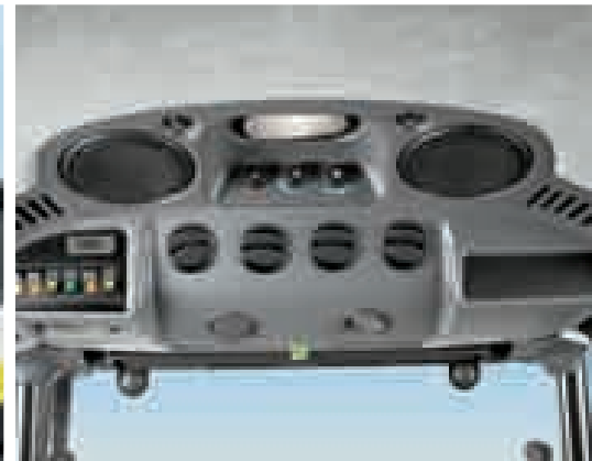
Die Bedienung für Heizung und Klimaanlage ist übersichtlich im Kabinendach untergebracht.
